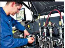
U ovlašćenom Boš servisu, na savremeni i veoma preciznim uređajima provode se ispravnost dizel-brizgaljki, a servisiranje neizbežno najopasnije, standard koje je propisao Boš. U Srbiji može postojati više od 30 ovlašćenih servisa, od čega je sedam specijalizovano isključivo za servisiranje dizel-komponenti
